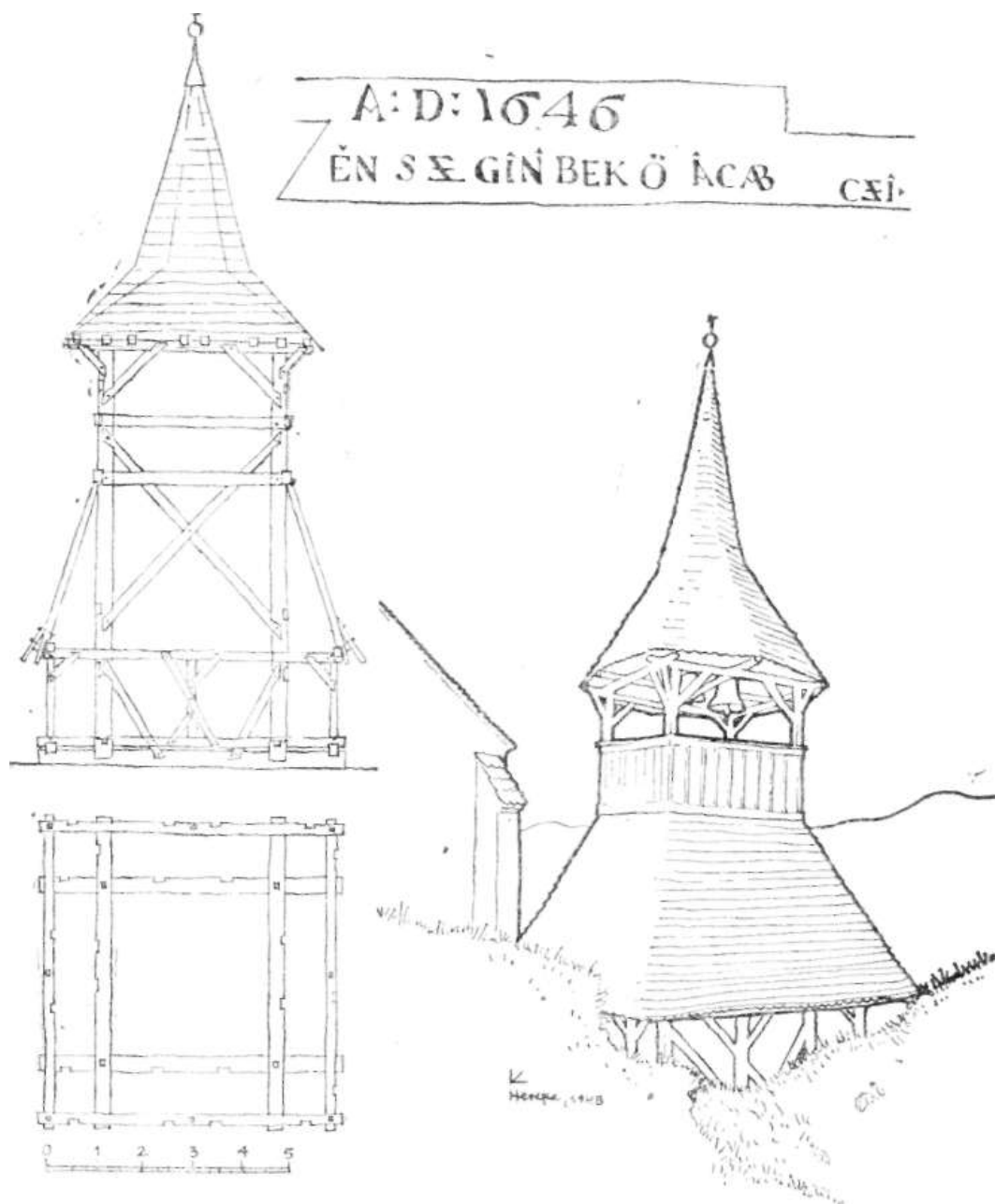
57. A herepei harangláb (felirata: A[NNO] D[OMINI] ÉN SZEGINI BEKÖ JACAB CZI[NÁLTAM]), távlati és szerkezeti rajzok, valamint a koszorúgerenda felirata.
