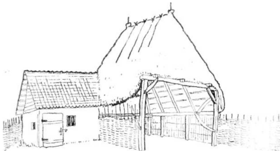
27. Cséplőcsűr a jobbágy időkből, 3 m-es jármokkal, azaz csűrhargasokkal , utólag hozzáépített kamarával , Királyfalva (Szántó József a Suszteré).
