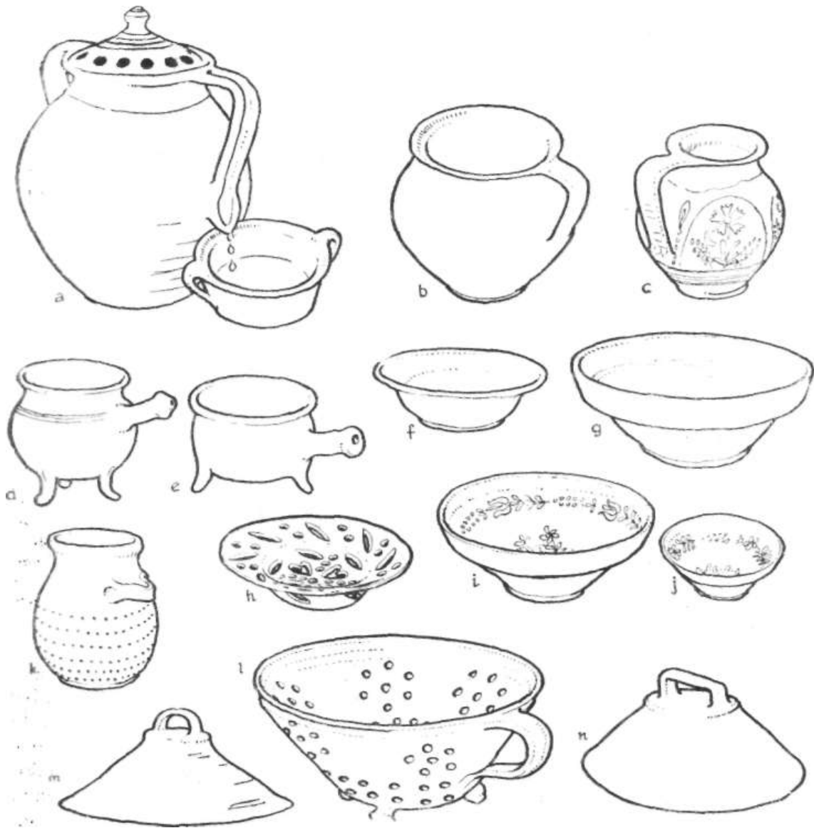
12. rz. Désházán és Zilahon készült edények: a. régi káposztafőző (fazék), a füle csatornáján folyik le a pára az oda helyezett lábosba, b, c. szilkék , d. régi forma lábos , e. tokos lábos , f. tányér , g. tál , h. palacsintas tányér , i-j. falra való nagy- és kistál , k. paradicsomszűrő , l. tésztaszűrő (laskaszűrő), mind Désházáról, m, n. mázatlan és mázas nagyfedők (lábosra), Zilahról.
