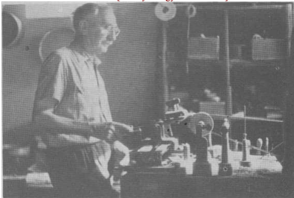
A lábbal hajtott fogvágógép könnyebbé és termelékenyebbé tette a munkát
