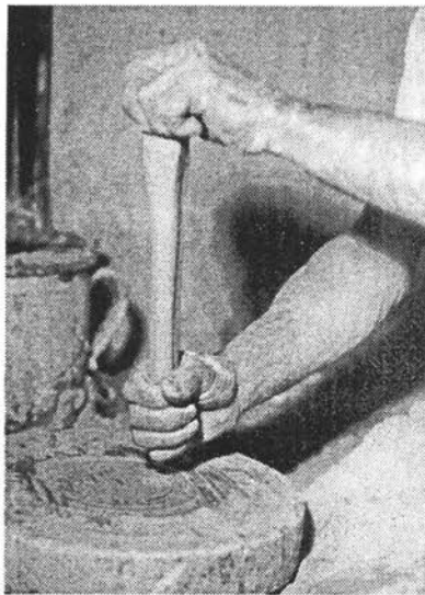
A fül fejőmozdulattal való véglegesítése
