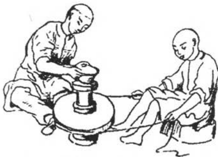
Zsineggel hajtott korong az ókori Kínából, apud Slătineanu B., fig. 32.
