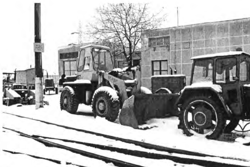
Talajgyengítéshez használt összkerék hajtású traktor és áramfejlesztőt vontató
