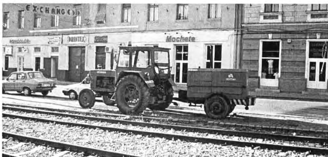
Universal U650 traktor hegesztéshez használt dízelmotoros áramfejlesztő utánfutóval
