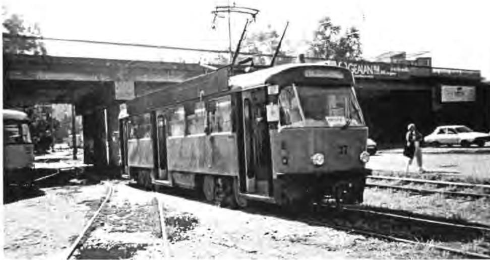
Előlről csak a szokatlan helyű féklámpa árulkodik arról, hogy ez egy T4D-ZR típusjelű még Magdeburgban kétirányúvá átépített motorkocsi. 2004-ben átszámoltak ex 33-ról 37-re
