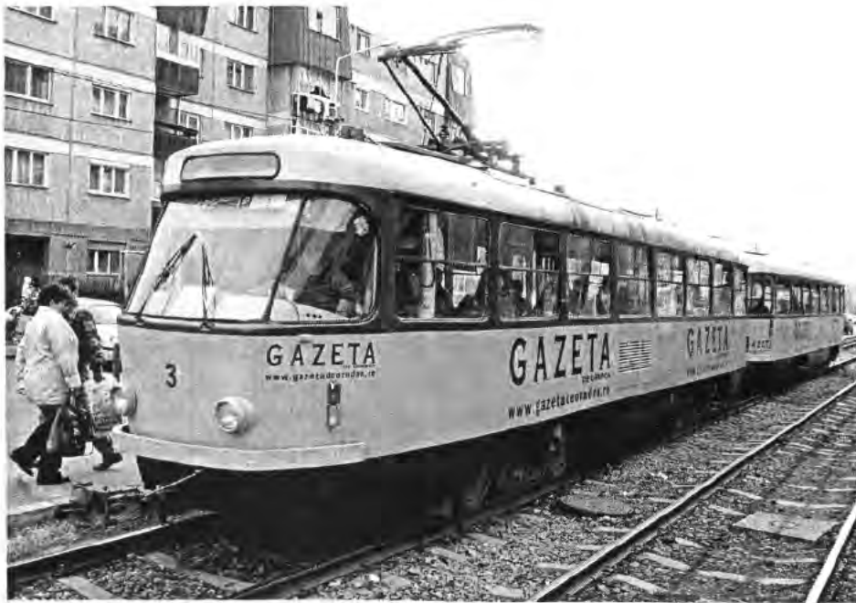
A 3+103-as első látásra drezdai származásúnak tűnik, de van egy pár áruklodó jel, mint az áramszedő, az oldalsó lámpák alacsonyabb helyzete, vagy a hátsó lámpák
