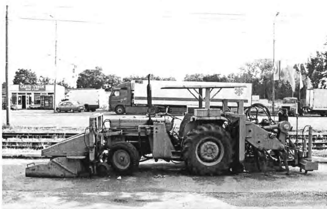
Pályafelújításhoz és emeléshez, valamint nyomtáv beállításához használt sínenjárásra is alkalmas traktor alapú jármű
