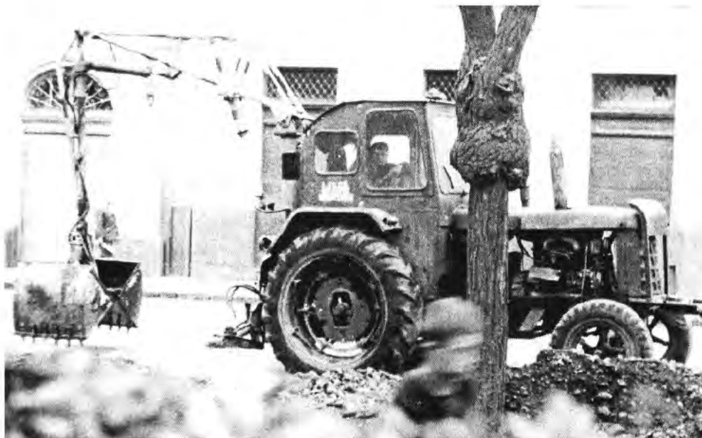
Traktorra szerelt markoló 1980-ban. Valószínűleg ugyanezt a traktort alakították át szerviz célokra
