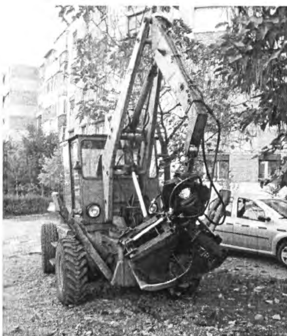
Sín és talpfák emeléséhez és mozgatásához használt markolós traktor
